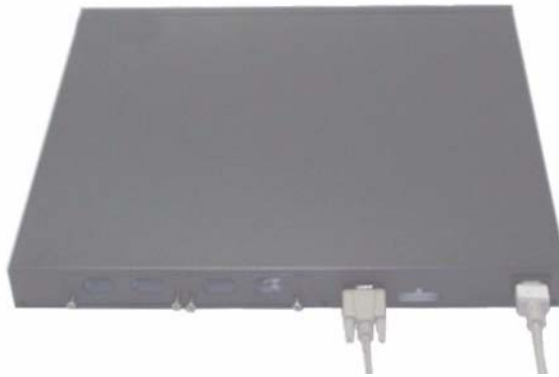
Figura 1-4. Conexión al puerto de la consola
